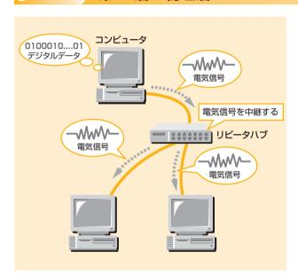
物理層の役割は、コンピュータとケーブルを 接続し、コンピュータが理解できるデジタル データとケーブルが扱う電気信号を相互に変 換することです。
