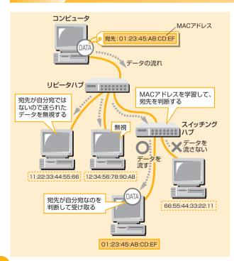
データリンク層の役割は、ケーブルで直に接続されている同一ネットワーク内で、正確なデータ伝送を実現することです。デジタルデータと電気信号の変換のみを行う物理層に対し、データリンク層では、誰から誰に伝送されたデータなのかを判断します。このときに使われるのが、第2章で学習したMACアドレスです。また、データリンク層では、データが壊れていないかどうかも判断します。
