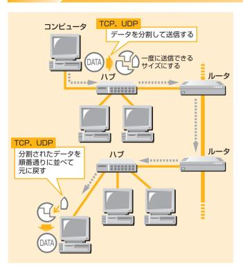
トランスポート層の役割は、データ伝送 の信頼性を提供することです。送信元か ら送り出されたデータが、送信先に正し く確実に届けられる通信を提供します。
